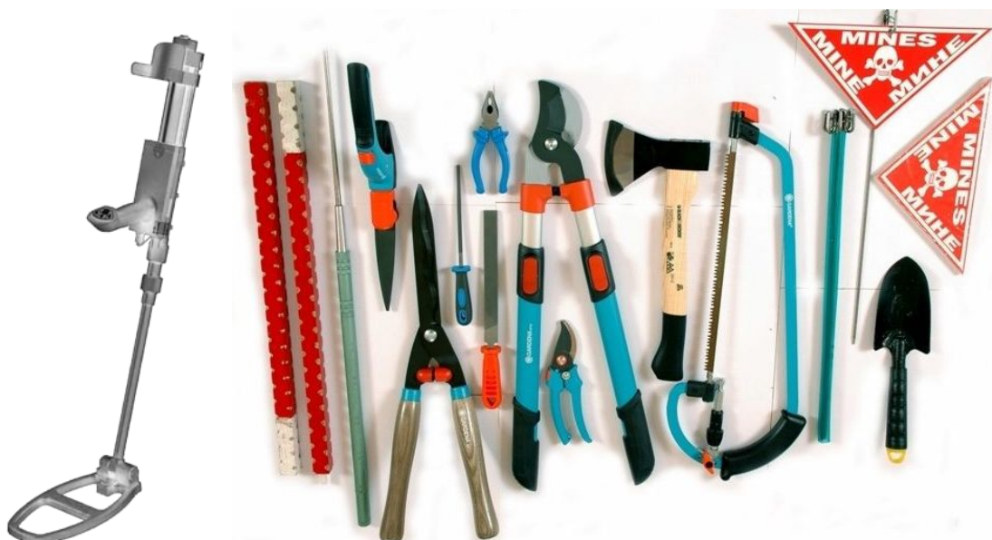
Primjer sadržaja individualnog kompleta alata deminera
